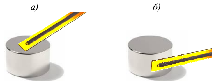
Рис.3.6. Измерение нормальной составляющей вектора индукции постоянного магнитного поля на торцевой (а) и боковой (б) поверхности стального изделия
